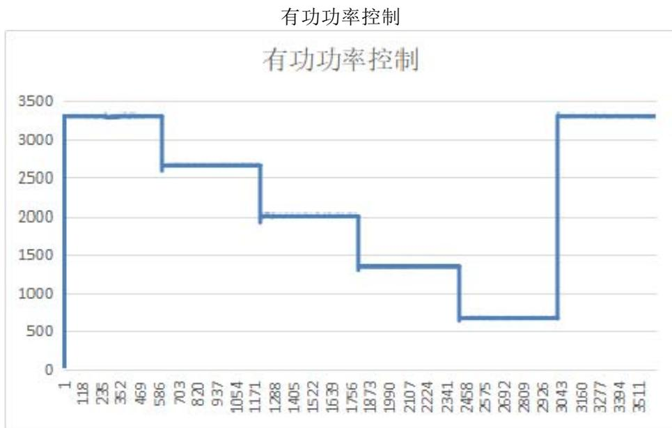
最大有功功率控制精度 0.45%, 最大响应时间0.6s
