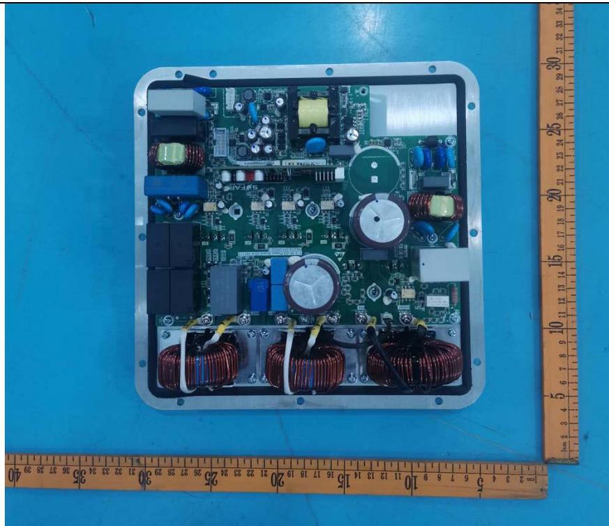
图25 机体内部布局图-拆除上盖（样品型号：SOFAR 2200TL-G3系列）
