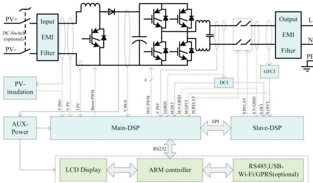
图29 主电路电气原理图
