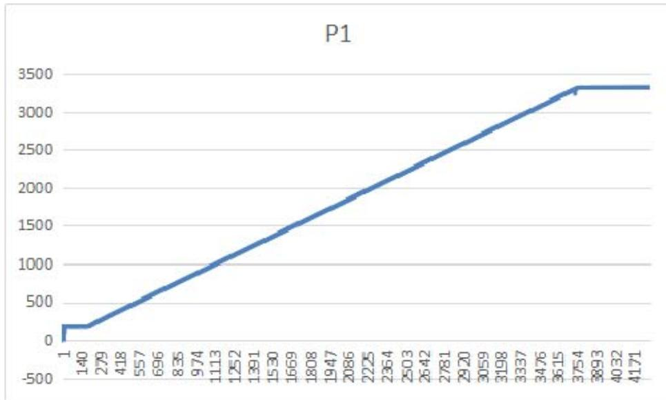
逆变器具有有限有功功率变化速率的功能；若没有，其最大有功功率变化速率为 $\pm 10\%P_n/\text{min}$ 。交流侧的最大峰值电流为14.4A符合要求。
